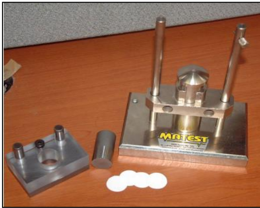
Plate 4.12 Standard Rigden void apparatus
